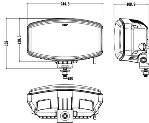
Complétez votre camion avec le phare Atlas 320 LED de TRALERT® (Art. WD-4830). Ce phare LED de dimensions courantes est équipé de LED puissantes d'une puissance lumineuse totale de 3 000 lumens. En outre, l'Atlas 320 est équipé de feux de position bicolores, ce qui fait de cette phare longue portée un excellent complément pour votre camion en termes d'esthétique et de fonctionnalité.
