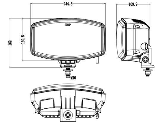
Toutes les fonctionnalités dans un phare LED au format populaire: l'Atlas 320+ de TRALERT® (Art. WD-6060A). Ce phare longue portée LED est doté de puissantes LED avec une puissance lumineuse totale de 6000 lumens. En outre, l'Atlas 320+ est équipé de feux de position diurnes bicolores et d'une torche LED certifiée R65, ce qui rend inutile l'installation de torches séparées sur votre support de toit, par exemple.
