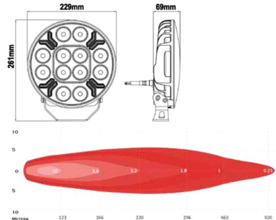
Alle Funktionen in einem LED Fernscheinwerfer: die TRALERT® Ypsilon Serie 12LED. Das Upgrade für Ihr Fahrzeug in Sachen Ausstrahlung und Funktionalität. Die Ypsilon-Serie besteht aus zwei Modellen, von denen dies die größere Variante ist. Der WD-12080.1 hat eine Lichtleistung von nicht weniger als 8.000 Lumen, sodass Sie die Straße unter allen Bedingungen optimal ausleuchten können.
